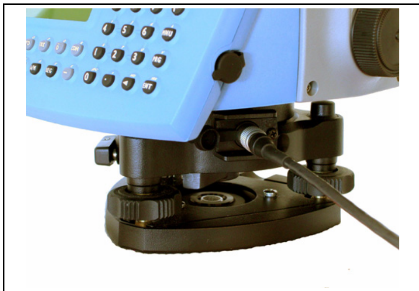
Рис. 2.4 Подключение внешней батареи к инструменту.
